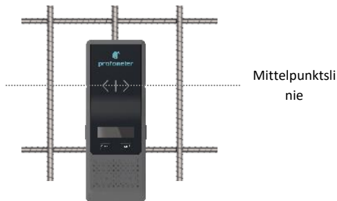
Abbildung 35: Sensor an der Mittelpunktslinie positioniert
