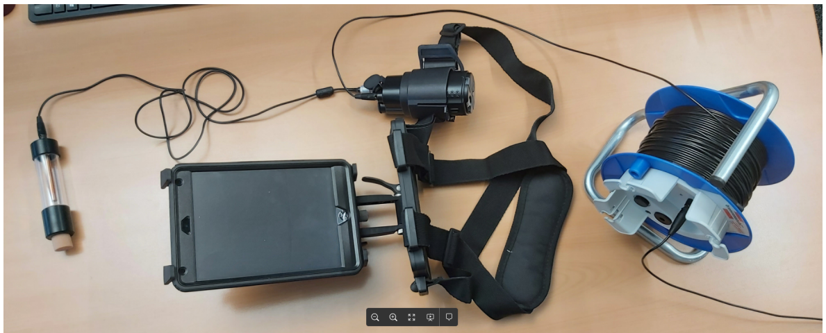
Abbildung 7 : PM8500 Kabelkonfiguration für Stabelektrode
