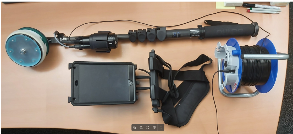
Abbildung 8 : PM8500 Kabelkonfiguration für 1-Rad Elektrode
