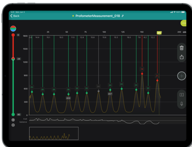
Figura 53: Vista completa de escaneo de línea con vista de intensidad de señal
