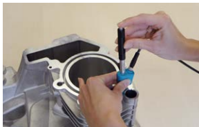
Figura 4: Procedimiento de ensayos Leeb
