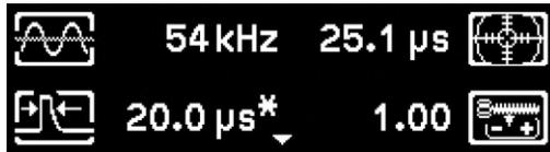
Частота Tx, калибровка, ширина импульса, температурная коррекция
