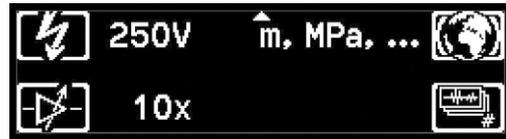
Усиление Rx, единицы, чувствительность приемника, режим передачи
