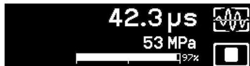
Измерение прочности на сжатие (Pundit Lab+)
