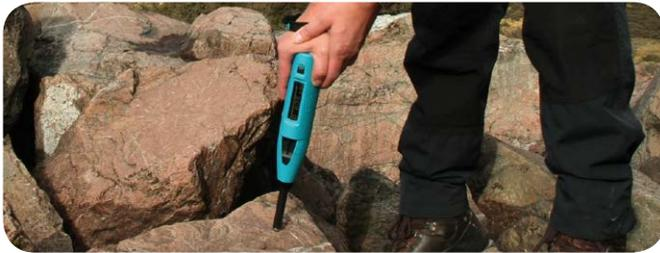
Lo sclerometro più avanzato al mondo con caratteristiche ineguagliabili di dispersione, durabilità e range di misura è stato ora adattato per le prove su roccia. Le seguenti funzioni rendono lo strumento particolarmente adatto per le applicazioni di prove su roccia:
