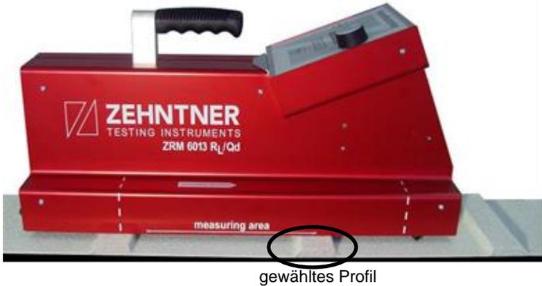
2. Das Gerät um etwa 5 cm nach vorne versetzen und die nächste Messung vornehmen.
