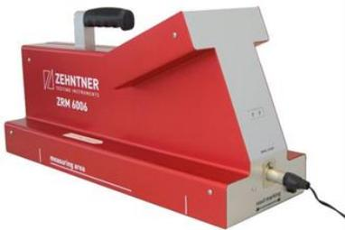
Zum Aufladen des Akkus den Ladegerät-Stecker in die Anschlussbuchse am ZRM 6006 einstecken und das Ladegerät an eine Steckdose an (100 - 240 V, 50 - 60 Hz) anschliessen.
