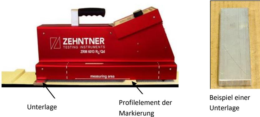
Die Unterlage muss **immer** am hinteren Ende des Gerätes platziert werden, und soll maximal bis zu den Schrauben der Grundplatte gehen, zu allen anderen Seiten unlimitiert.
