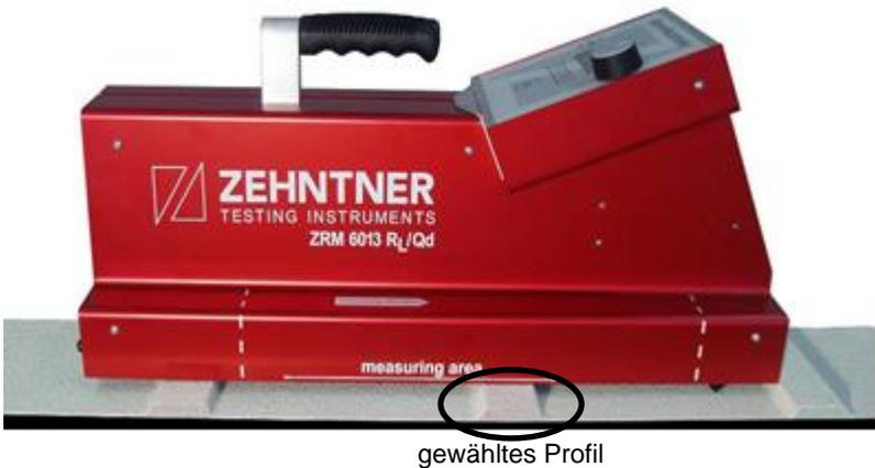
3. Das Gerät erneut nach vorne versetzen, so dass Punkt A in der Mitte des Profils liegt. Die dritte Messung auslösen.
