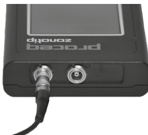
Рис. 4: Подключение преобразователя на 2,5 МГц.
