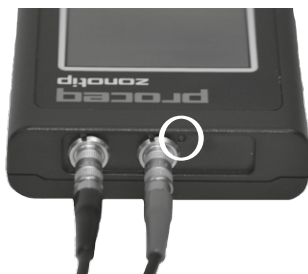
Рис. 3: Подключение преобразователя на 4,0 МГц. Убедитесь, что красный кабель подключен к порту с красной точкой.
